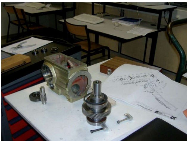
REDUCTEUR EN COURS DE DEMONTAGE
